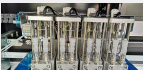
Podciśnieniowy system wyrównawczy atramentu
